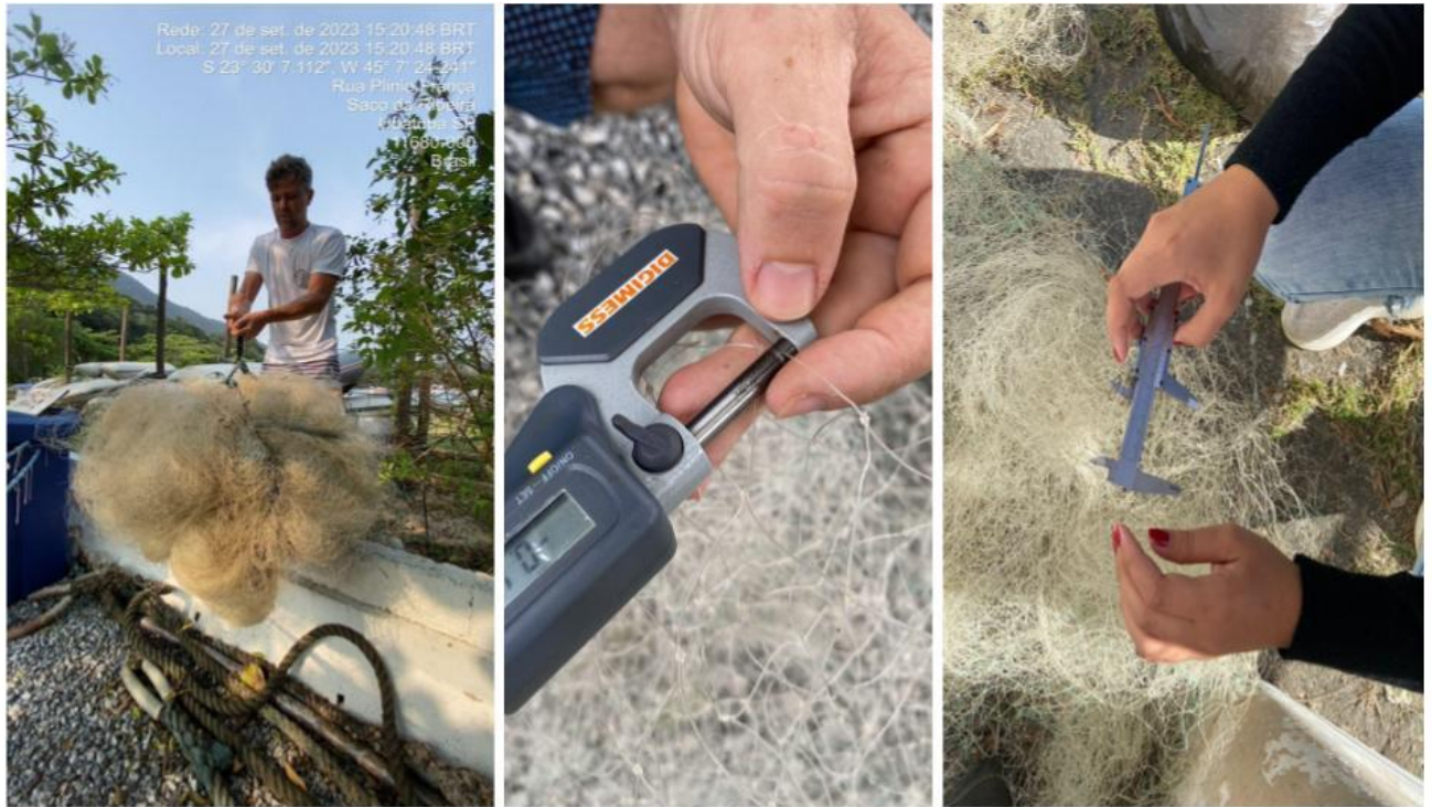
Figura 24. Caracterização dos petrechos de pesca, através da medição do peso (kg), espessura do fio e medição do tamanho da malha das redes recebidas. O processo de caracterização foi realizado ao longo de 36 meses de execução do Projeto Petrechos de Pesca, desde a abertura do Ecoporto do Pescador em maio/2023.
