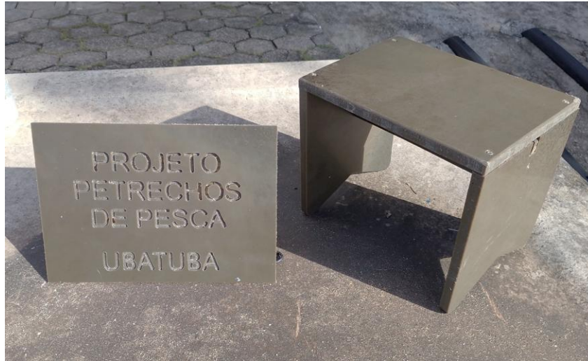
Figura 31. Protótipo de placa gravada e banco, confeccionados a partir de pellets de redes recicladas pelo Projeto Petrechos de Pesca, Ubatuba/SP.
